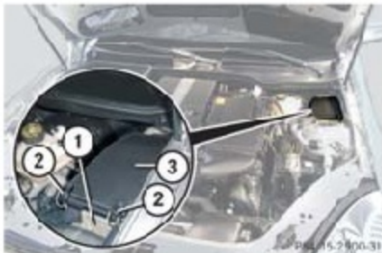
① Hauptsicherungskasten ② Halteklammern ③ Deckel
