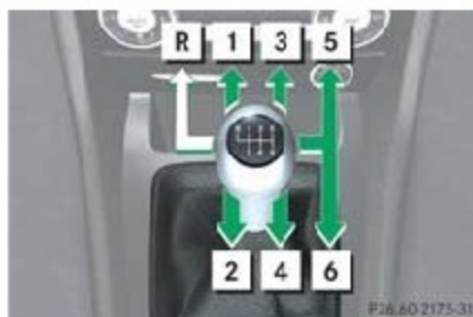
Schaltschema des Schaltgetriebes
