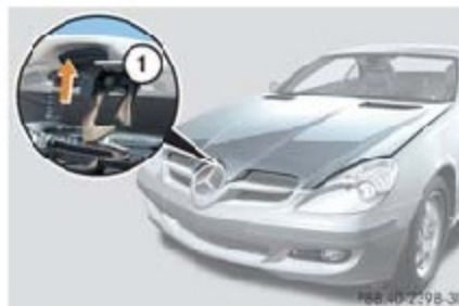
① Griff der Motorhaubensicherung
