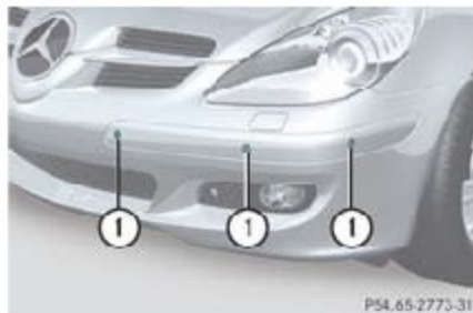
① Sensoren im vorderen Stoßfänger
